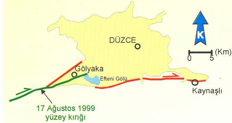
Şekil 6: 17 Ağustos 1999 depremi ile gelişen yüzey kırığı
